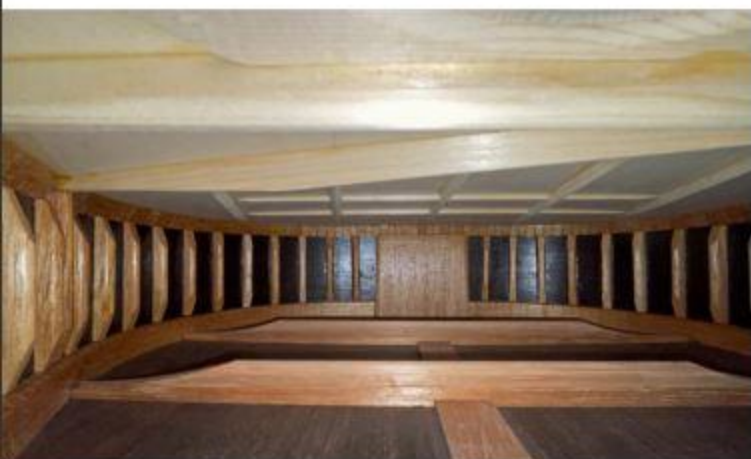
En lugar de hacer aros dobles, los refuerza con pequeñas columnas de cedro.
