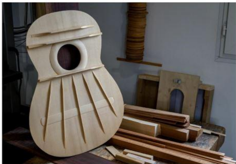
EL varetaje de cinco varetas que utiliza para las guitarras de flamenco.
