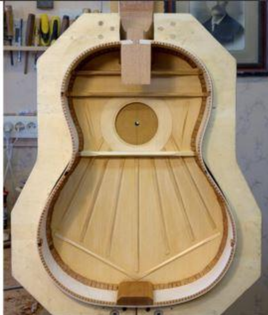
Copia de una Torres, en curso de construcción con refuerzo de aros tradicional en caoba.
