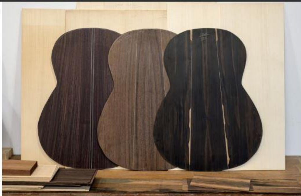
Hacer fondos en varios trozos es una buena solución para utilizar las mejores partes de un tablón y para dar rigidez al fondo.
