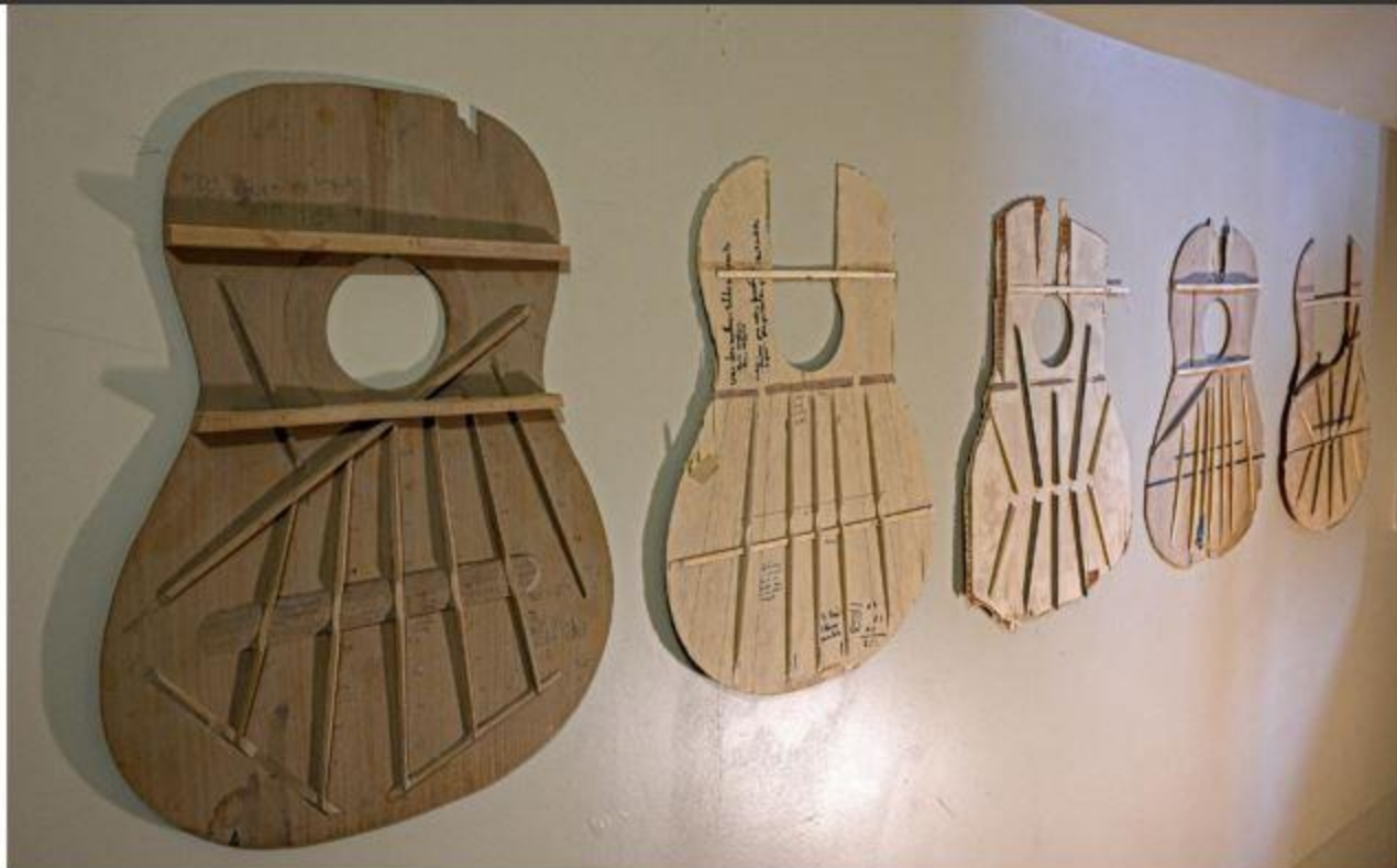
Sur un mur de son atelier, on voit divers essais de barrage faits pour mieux comprendre le comportement acoustique des guitares.
