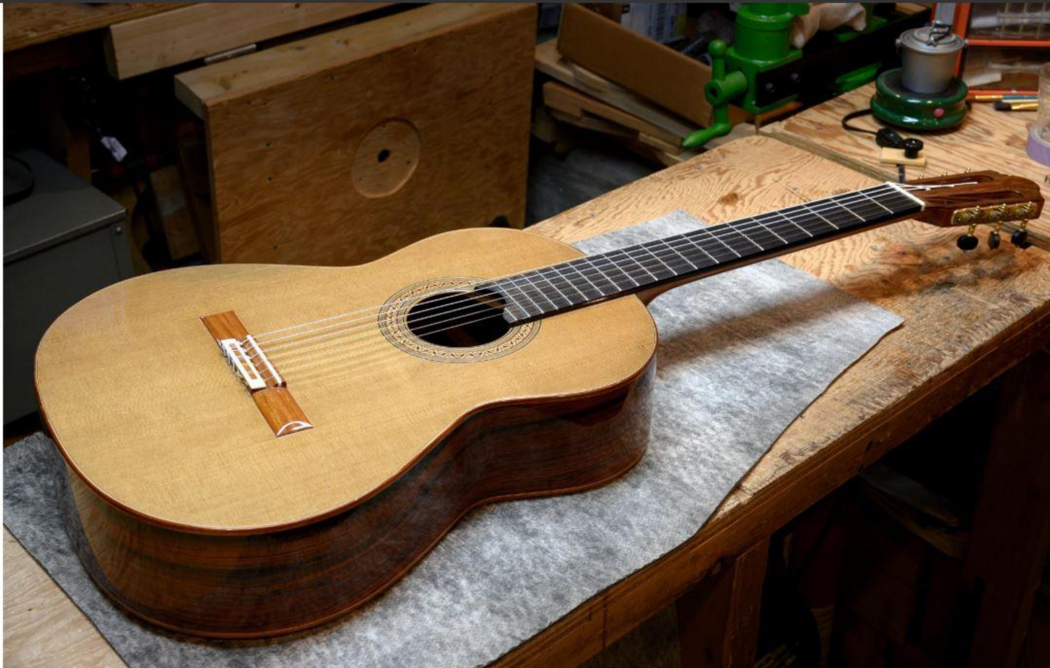
Modèle Morency 2018 : table en cèdre, fond et éclisses en palissandre du Honduras.
