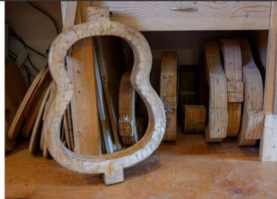
Différents moules utilisés dans la construction de ses guitares.
