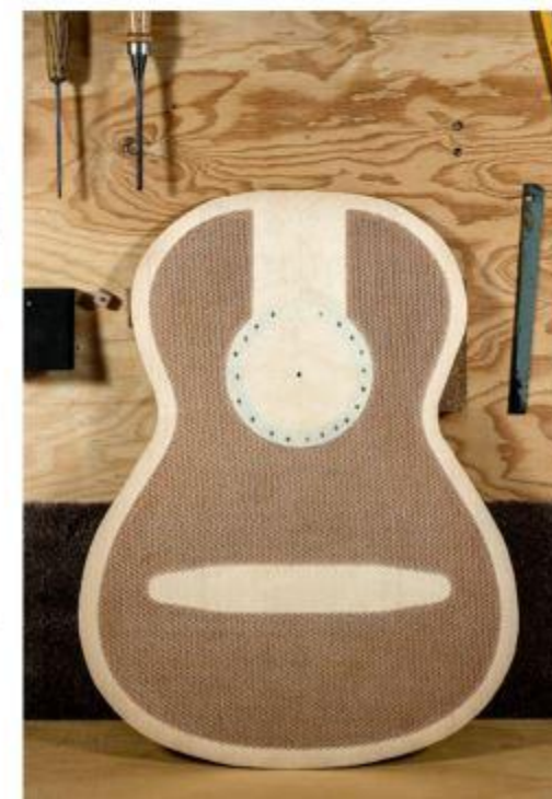
Double table en cours de construction avec la couche de Nomex déjà collée.
