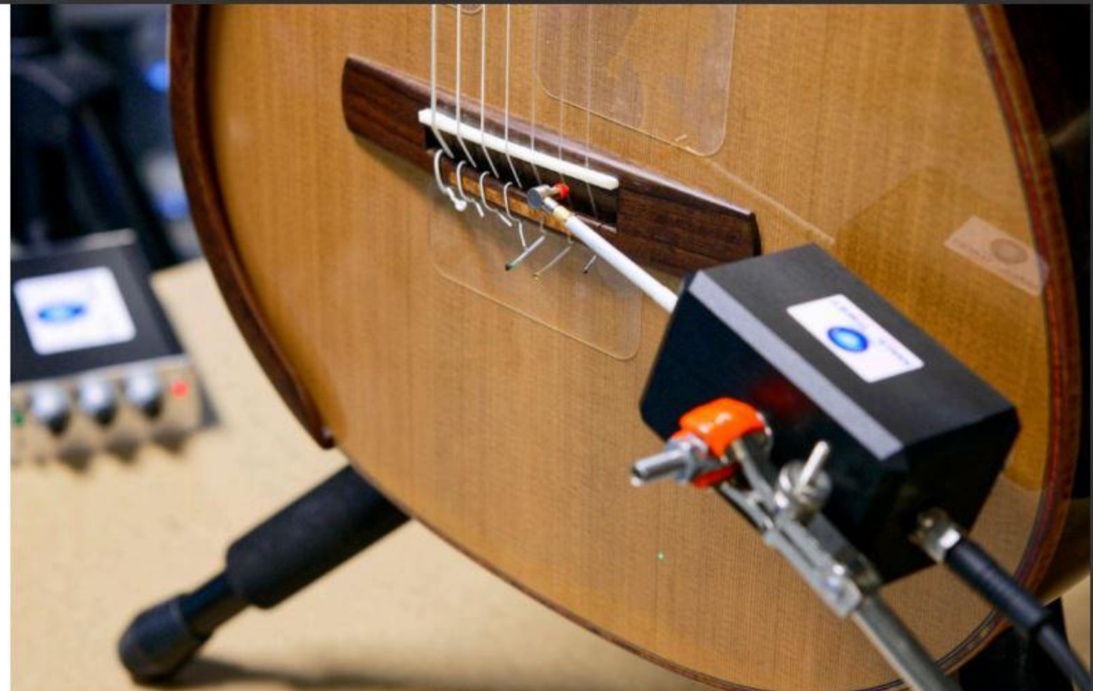
El vibrómetro laser mide los impactos aplicados en la cejilla del puente.
