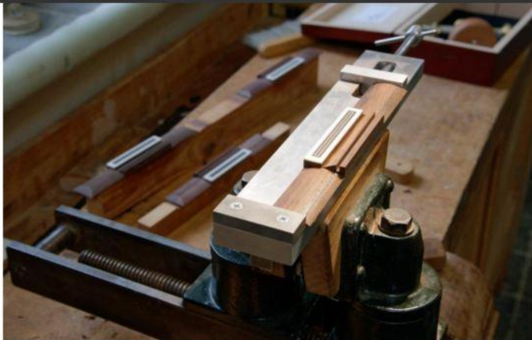
Herramienta especial para trabajar en el puente y su decoración.
