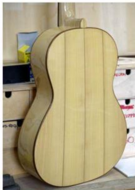
Guitarra del proyecto Leonardo, con mástil de fresno y caja de boj.
