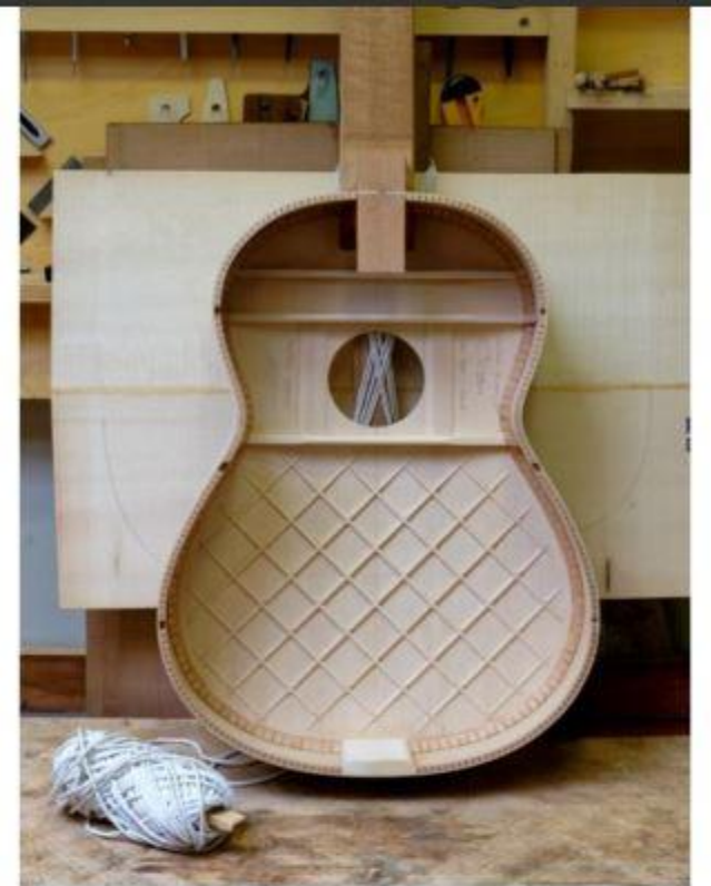
El modelo Rondine con su tapa de abeto y su varetaje tipo “lattice”.
